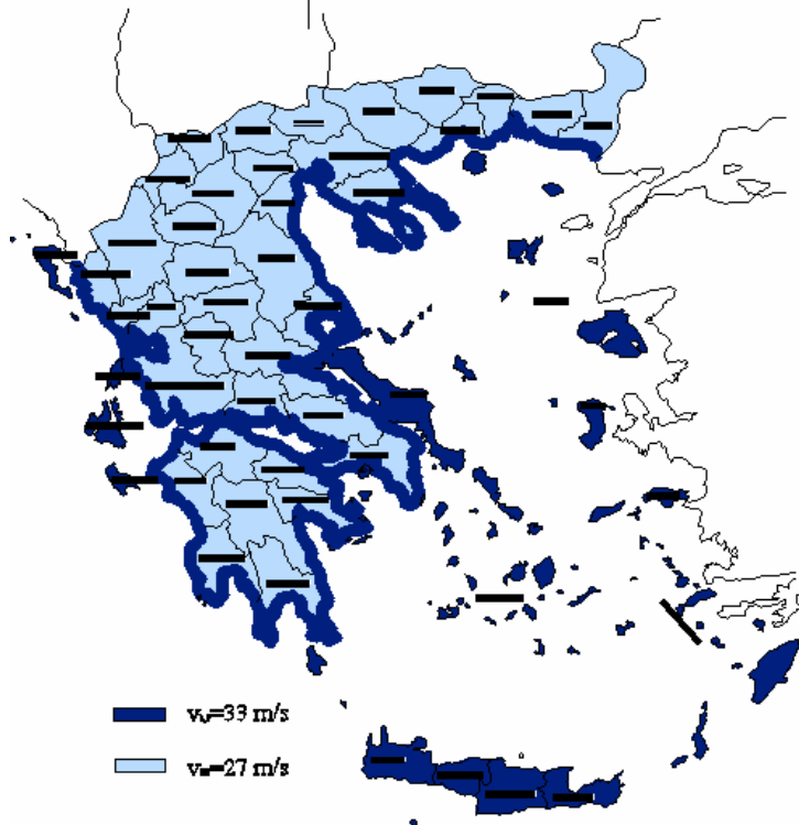
Σχήμα 1: Χάρτης θεμελιώδους βασικής ταχύτητας του ανέμου.
